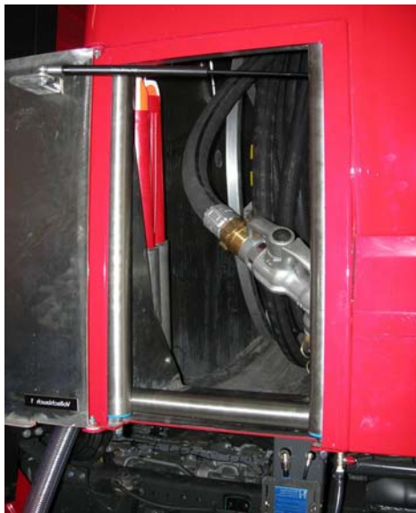
Abgabeeinrichtung in Integriertem App. Schrank auf der rechten Fahrzeugseite
