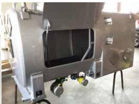
**KS/2: Weiterentwicklung von KS/1** mit zusätzlichen Anschlüssen, Pumpe und erweiterten Simulationmöglichkeiten. Transport auf einem Anhänger und für den Einsatz in der Theoriehalle geeignet.
