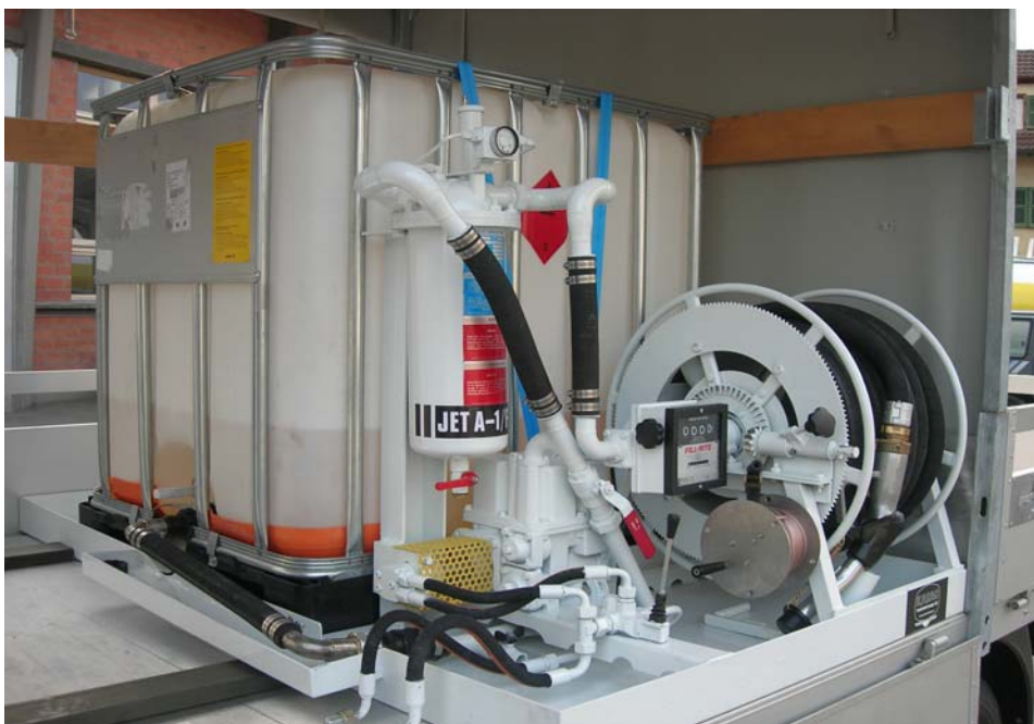
Abgabesystem mit Flügelzellenpumpe, Stufenloser Reguliermöglichkeit 5 - 80 L/min., Fill-Rite Zähler
