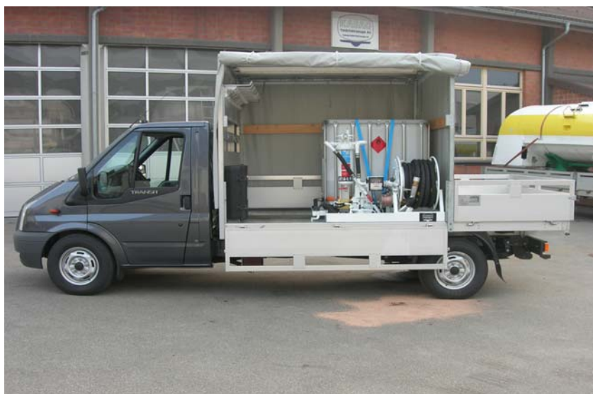
Allrad Trägerfahrzeug mit Ausrüstung für den Helikopterbetrieb abseits des Flugfeldes
