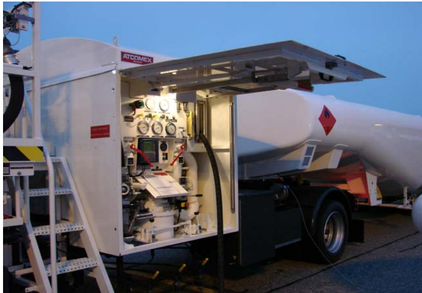
Abgabesystem mit Gormann Rupp Mediumpumpe, Haar Inline Druckregelung, Smith Meter und Bartec TMU
